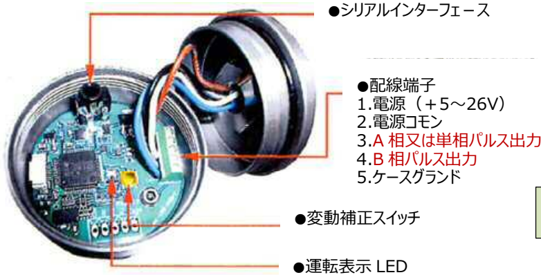
CPU 基板内蔵リモートボックス (高温タイプ用計測出力部)
