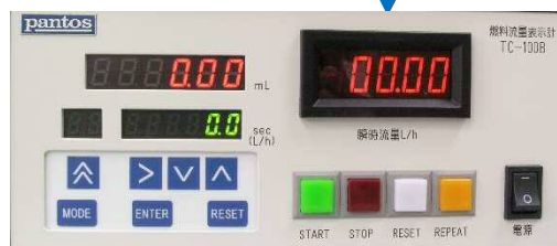
燃料流量表示計 TC-100B/100BD 外形寸法 : W220×H99×D200
