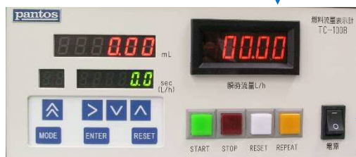
燃料流量表示計 TC-100B/100BD 外形寸法 : W220×H99×D200
